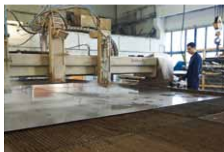
Vattenskrämaskinen där aluminium i storlekar upp till 4x9 m skärs med 3000 bars tryck.
