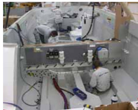
Här pågår elinstallationen.
